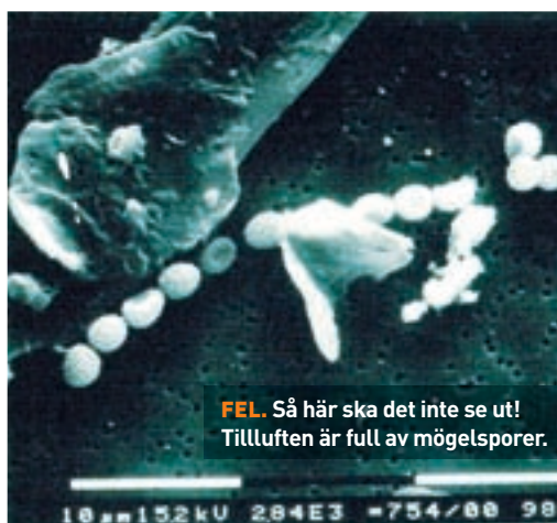
DAMMTÄCKE. En dåligt rensad frånluftskanal försämrar hela ventilationssystemets funktion med sämre inomhusluft som följd.
