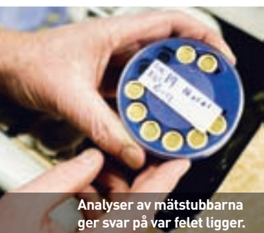
STUBBE. Med hjälp av en mätstube mäter Rolf Nybom luftkvaliteten i olika delar av ventilationssystemet.
